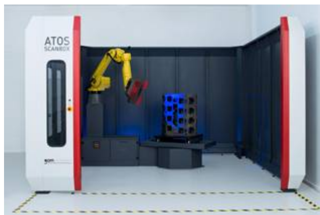
La métrologie 4.0 en libre-service dans les ateliers : La ScanBox de GOM. Elle encapsule les règles de bonnes pratiques pour les mettre à la disposition des opérateurs au sein même de la fabrication.
