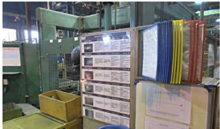
Consignes au poste de coulée sur ligne de moulage avec tableau de défauts.
