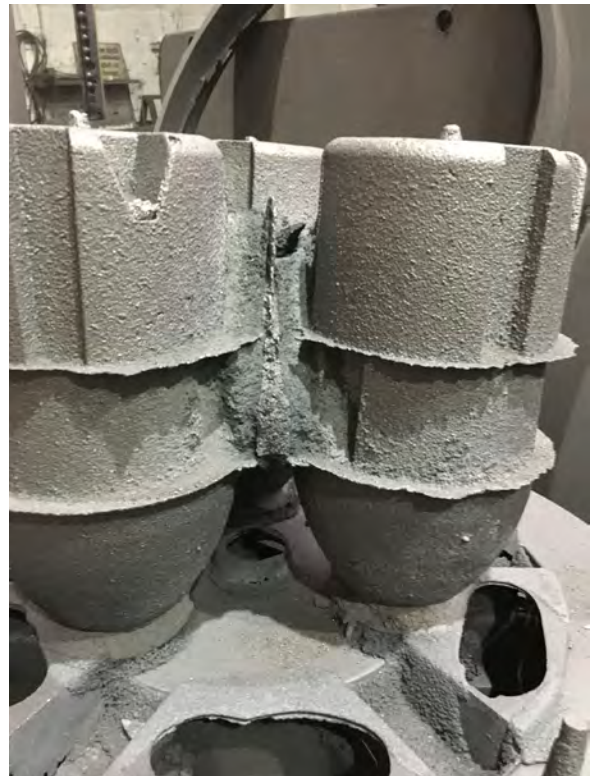
Figure 6 : disposition de trois masselottes de module 6,8
