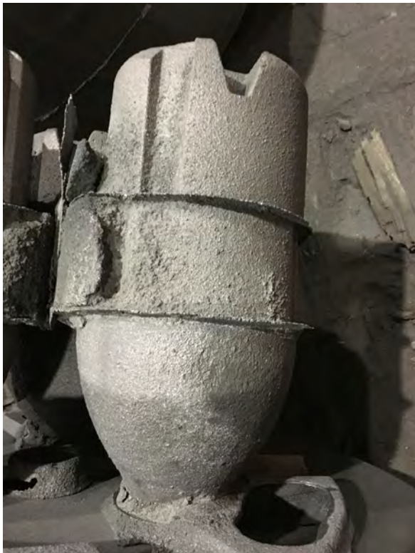
Figure 5 : masselotte après décochage • module de 6,8 cm
