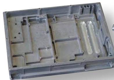
Ailettes de refroidissement sur un boîtier électronique : 2 soudures FSW pour assurer la conductivité thermique.
