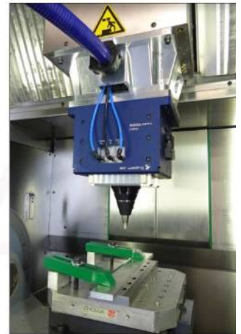
Tête FSW installée
