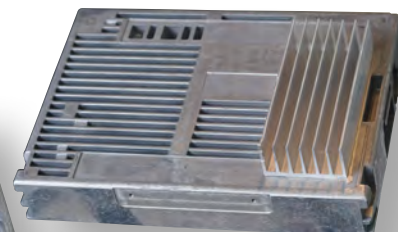
Ailettes de refroidissement sur un boîtier électronique : 2 soudures FSW pour assurer la conductivité thermique.
