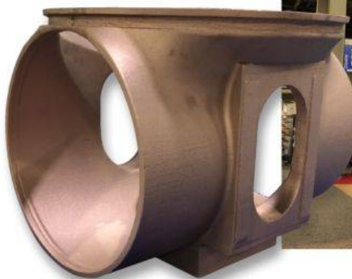
Centre de corps d'essai pour particule à haute énergie en cuivre C110, fabriqué en imprimante 3D sable, par ROMAN Manufacturing (Grands Rapids, Michigan) 110 lbs
