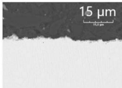
Figure 2 - Coupe d'une pièce en acier dans une zone ne présentant pas de céroxide (MEB - détecteur BSE).
