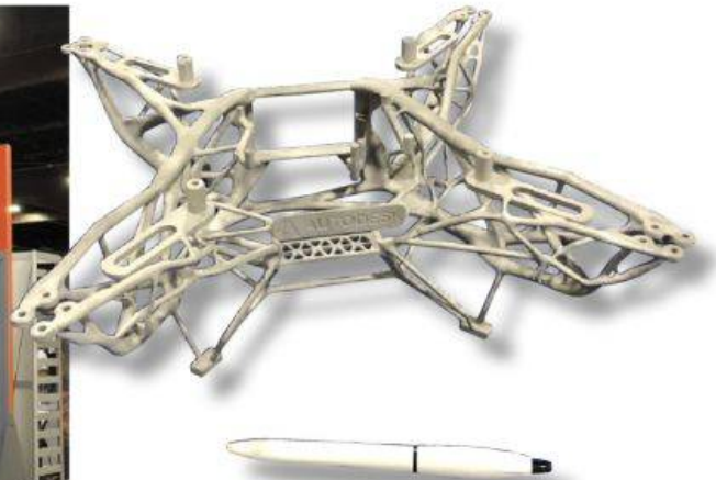
Châssis de drones pour inspection d'avion, en Magnésium réalisé en cire perdue par Aristo-Cast (Almont, Michigan) poids 0.628 lbs
