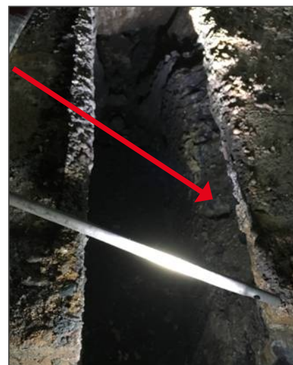
Séparateur laitier après 12 jours de service et usure laitier
