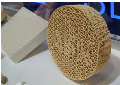
Filter réalisé par impression 3D
