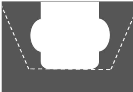
Illustration d'un re-chemisage du séparateur laitier et profil d'usure au niveau laitier
