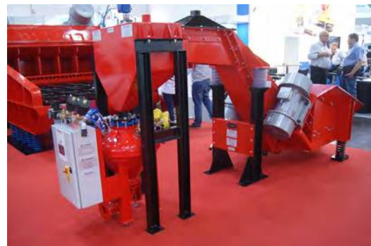
▲ Stand Omega : Décocheuse de moule en sables à prise chimique
