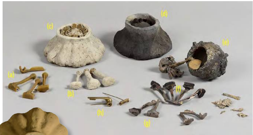
Fig. 1 - Les différentes étapes du procédé de moulage à la cire perdue. (a) Les modèles en cire, (b) Les modèles enrobés par la couche de contact, (c) Les modèles assemblés et enrobés par une seconde couche d'argile constituant le moule, (d) Le moule « déciré » après cuisson, (e) Le creuset et le métal à fondre, (f) La grappe de pièces brutes, (g) Les pièces séparées du dispositif de coulée, (h) les pièces finies.
