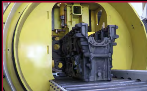
Station dessablage de 0 à 360° et martelage
