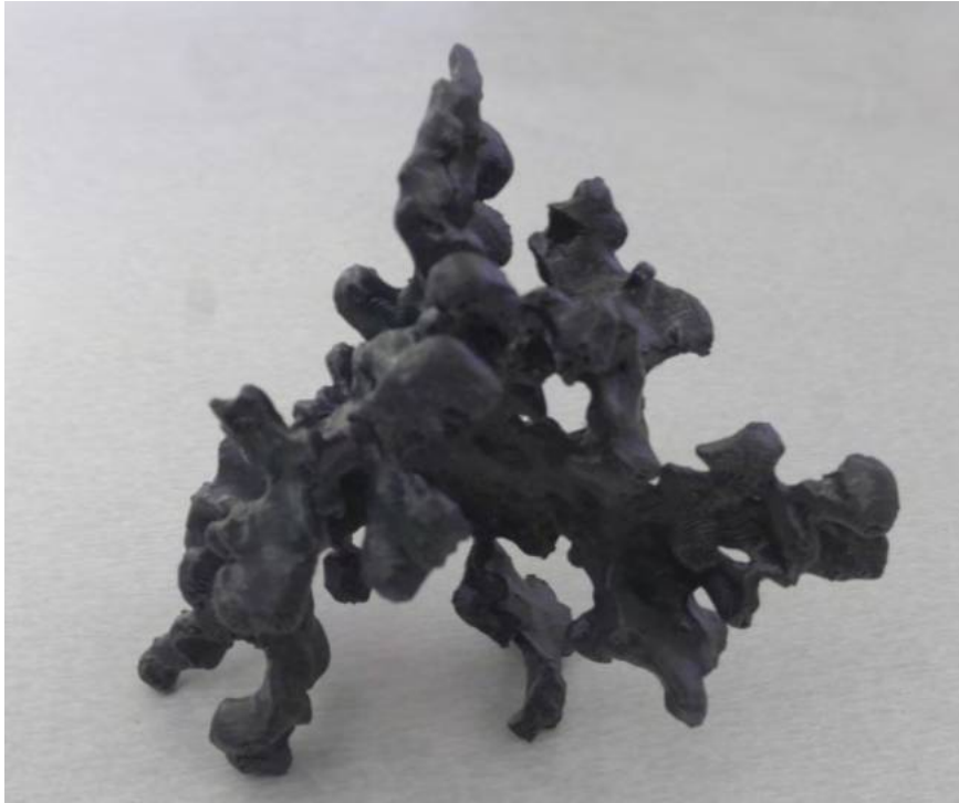
Figure 7 – Photographie d'une reconstruction 3D du graphite d'une cellule de graphite compact. Le modèle a été construit à partir des résultats de tomographie X réalisée avec un synchrotron [10].
