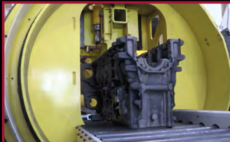
Station dessablage de 0 à 360° et martelage
