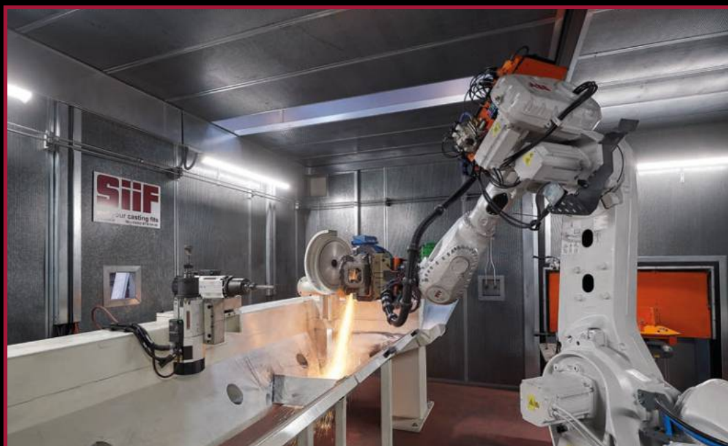
Station d'ébavurage avec meulage diamanté et compliance
