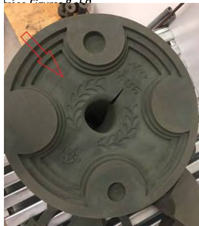
Figure 9 : Léger défaut linéaire d'impression
