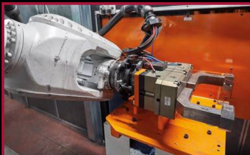
Changeur de préhenseurs en automatique
