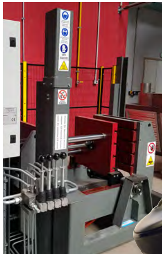
Le four de fusion et la coquilleuse basculante Photos publiées avec l'aimable autorisation de la Société BREFOND
