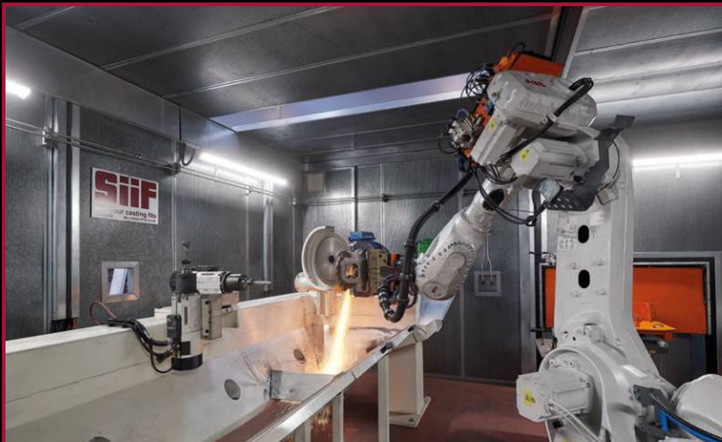
Station d'ébavurage avec meulage diamanté et compliance
