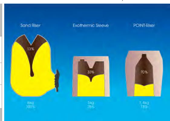
Figure 2. Schéma comparatif de masselotte traditionnelle / manchon exothermique / POINT-Riser®.
