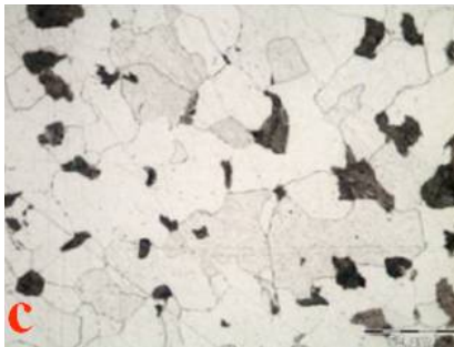
Figure 11. Evolution de la microstructure de l'acier en fonction du traitement : a) pièce brute ; b) recuit à 970°C et c) recuit à 1020°C
