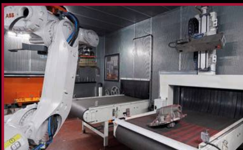
Convoyeur à bande avec vision 3D
