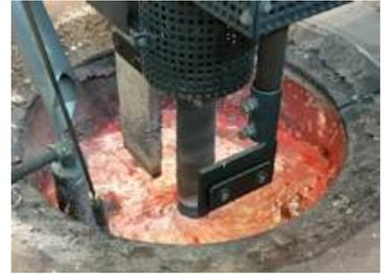
l'oxydation de Al ou des éléments d'additions de l'alliage (Mg, ...). Fortement influencé par l'oxydation de surface du bain d'aluminium, ainsi que par le transport et la réaction de grains réfractaires, tout au long du canal de coulée (mullite, spinelle, silicates,...)
