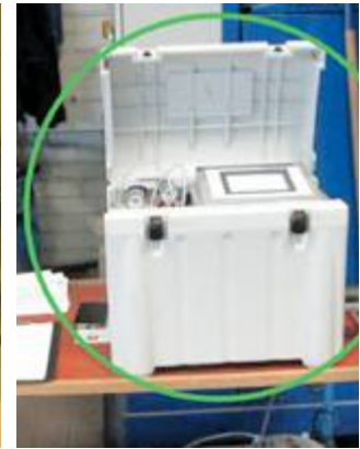
Figure 2 - FID en ligne pour la détermination de la teneur totale en carbone
