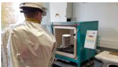
Fig. 8 - Mise en place d'un cylindre dans le four pour la cuisson du réfractaire
