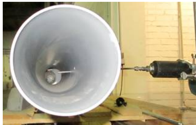
Figure 6 - Position du capteur dans le tuyau de sortie
