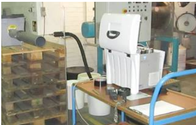
Figure 5 - Online FID pour la détermination de la teneur totale en carbone pendant le stockage du noyau
