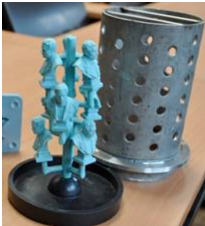
Fig. 7 - Mise en grappe et préparation du cylindre pour l'enrobage de plâtre réfractaire
