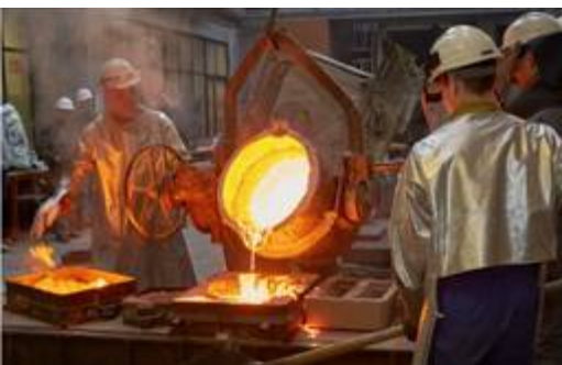
Dans les ateliers du lycée en mars 2019 : Un canon de 75 R 05 est coulé par les élèves. Photo Patrice Saucourt / L'Est Républicain
