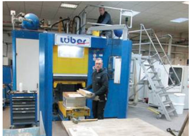
Figure 3 - Noyateuse dans le centre technique de fonderie ASK Chemicals à Hilden
