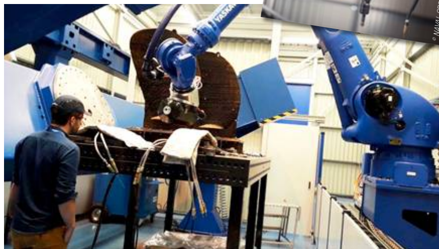
La cellule de fabrication additive d'Indret (© NAVAL GROUP)
