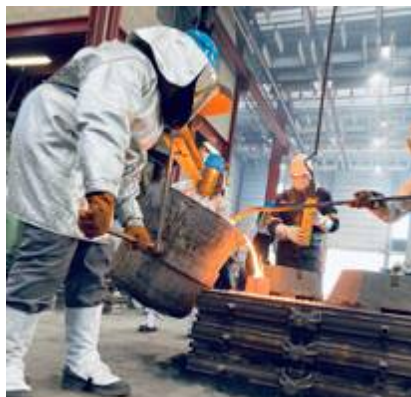
Remplissage des moules
