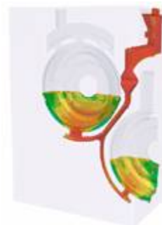
Figure 1 : suivi des particules lors du remplissage d'une cavité pour la fabrication de disque de frein.
