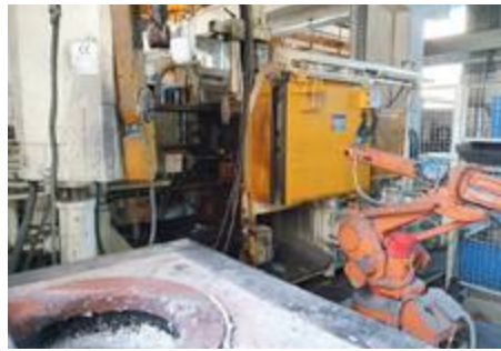
Presse à injecter chambre froide IDRA OL 100
