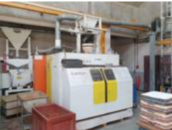
Machine à noyauter Laempe
