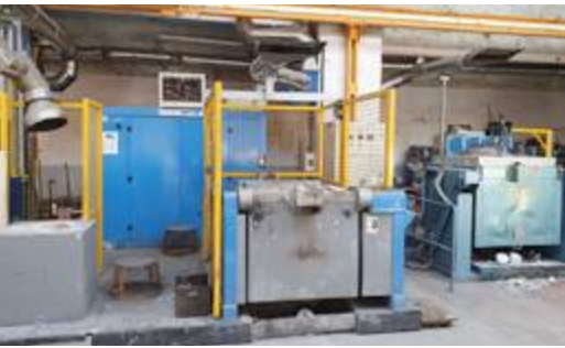
Fours électriques à résistances pour l'aluminium et à induction pour les cuivreux et ferreux
