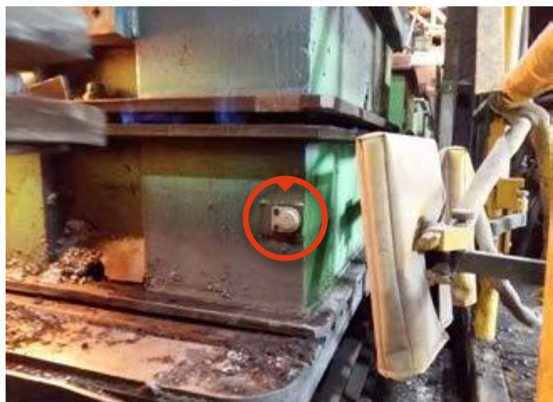
Fig 5. Les données du (des) noyau(x), du moulage et l'identité de la pièce (Cast Tracker) liées à l'historique du métal (Ladle Tracker) lors de la coulée.
