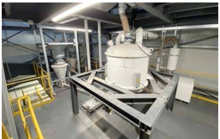
Classificateur/défineur de sable installé chez FBM
