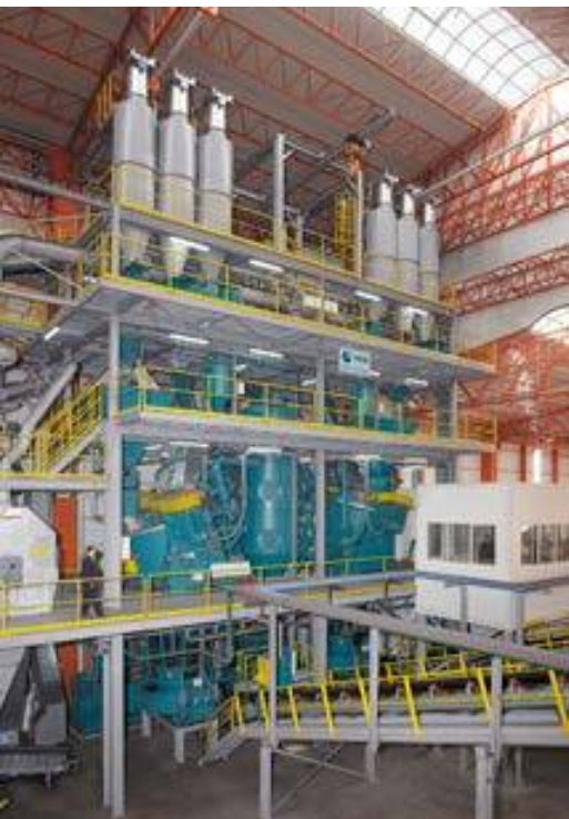
Atik Metal - Ensemble de deux unités EVACTHERM® pour le refroidissement et la préparation du sable de moulage sous vide pilotées par PLC et d'une capacité de 260 tonnes par heure
