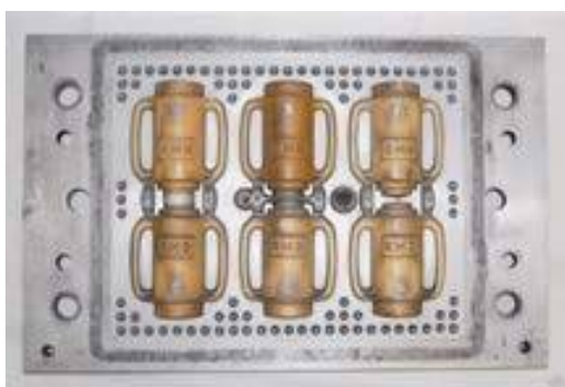
Chantier de moulage en mottes ROTOBLOCHMATIC Plaque modèle double face appareillée de mini cônes de centrage anti-variation - © GH-FML
