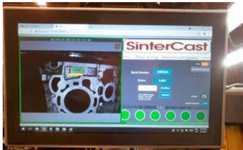
Fig 6. OCR System installé sur la ligne de production
