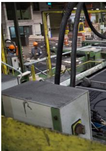
Chantier de moulage, 216 moules / heure
