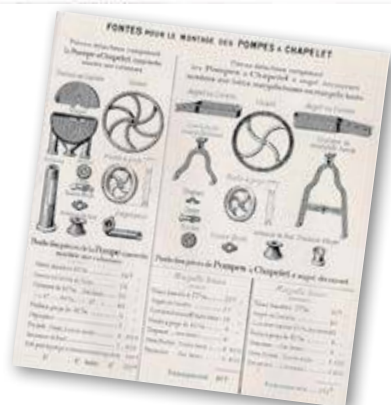
Éléments pour le montage de pompes à chapelet
