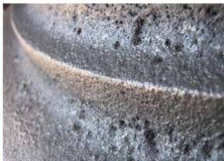
Fig. 1A : Défauts de surface causés par des taux de fluorine élevés dans le sable de moulage
