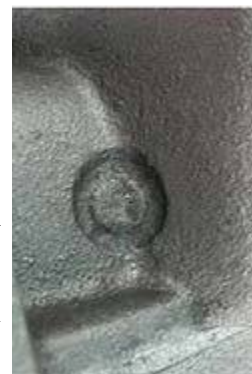
Fig. 1B : Défauts « fish eyes » se produisent par une réaction des particules exothermiques qui contiennent du fluor avec le sable du moulage
