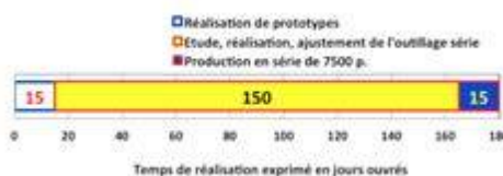
Fig. 1. Illustration de la durée de réalisation du prototype (fond blanc), de l'étude, de la réalisation, de la mise au point de l'outillage série (fond jaune) et de la production en série des 7500 premières pièces (fond bleu). Temps exprimé en jours ouvrés.
