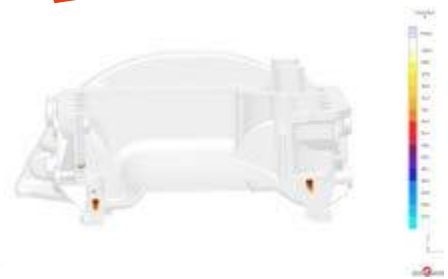
Fig 9. : Zones critiques subsistant dans la « meilleure » variante du deuxième plan d'essai virtuel.
