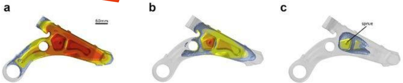
Figure 15. Séquence de solidification - représentée par les contours de la fraction solide limitée à 0,7.
