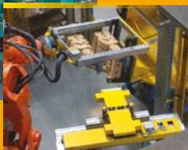
Robot d'assemblage de noyaux pour les noyaux de blocs moteurs
