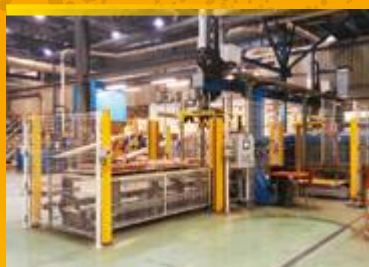
Unité de pose de noyaux
