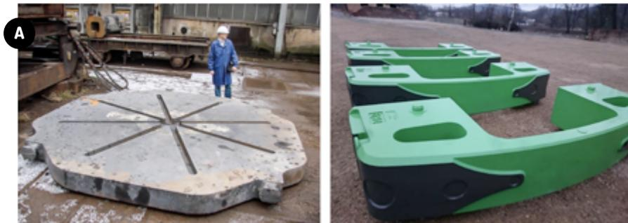
Fig 1. Exemples de plaques de base - jusqu'à 80 tonnes (a) et de contrepoids - jusqu'à 30 tonnes (b) produites par la fonderie Krakodlew s.A.
