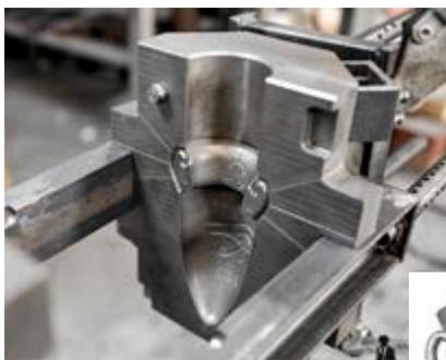
Figure 2 : Chape mobile de la coquille et coulée d'une amphore
