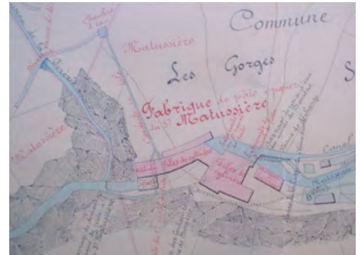
Plan des usines Matussière à Domène en 1880, alimentées par la grande chute de cent cinquante-sept mètres de hauteur Source : Archives Départementales de l'Isère, 752/37.
