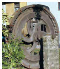
Turbine en fonte avec bras en « S » © Maison Bergès à Lancey.
