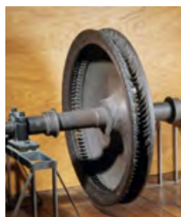
Turbines Girard : Vestige de la première turbine hydraulique à avoir fonctionné avec la chute d'eau de 200 mètres de haut. Elle porte des traces d'usure au niveau des aubages © Musée des Arts et Métiers-Cnam.
