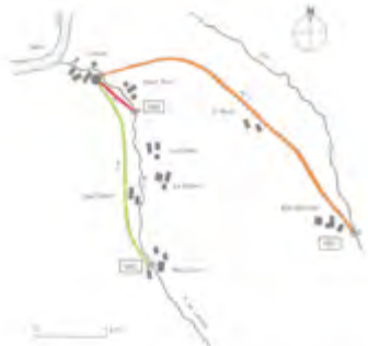
Les trois conduites forcées réalisées par Bergès pour alimenter l'usine de Lancey
